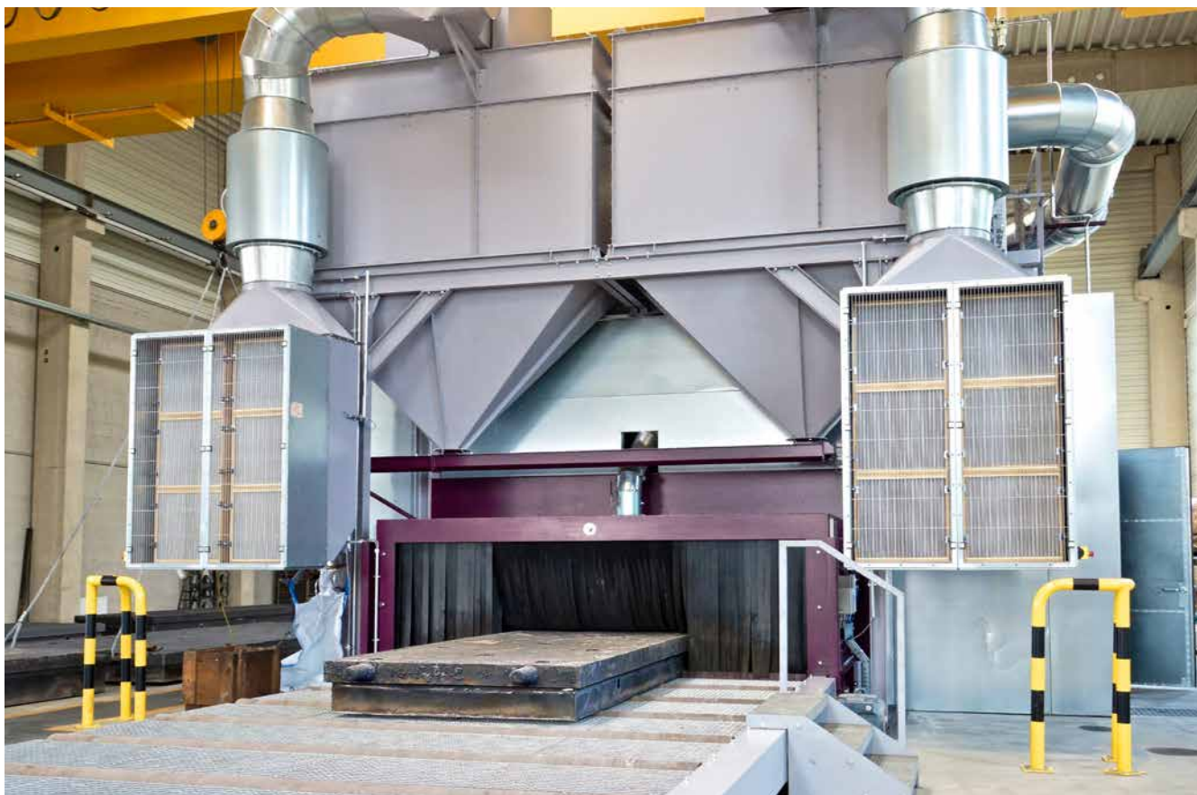
AGTOS fertigt Rollbahn-Strahlanlagen auch als Sonderanlagen. Die hier gezeigte Anlage ist ausgelegt für die Bearbeitung von gegossenen Aufspann-, Mess- und Prüfplatten von einem Gewicht von bis zu 25 t.
