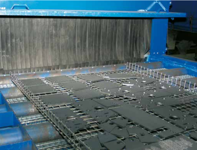
Strahlen von Brennschneidteilen im Korb
