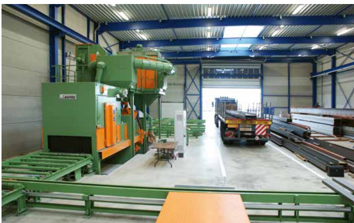
Quertransporte verbinden die Rollbahn-Strahlanlage mit den Säge-Bohr-Anlagen.
