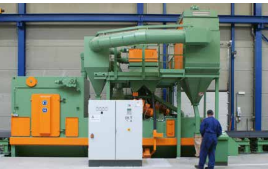
Die AGTOS Strahlanlage mit deutlich markierten Wartungstüren
