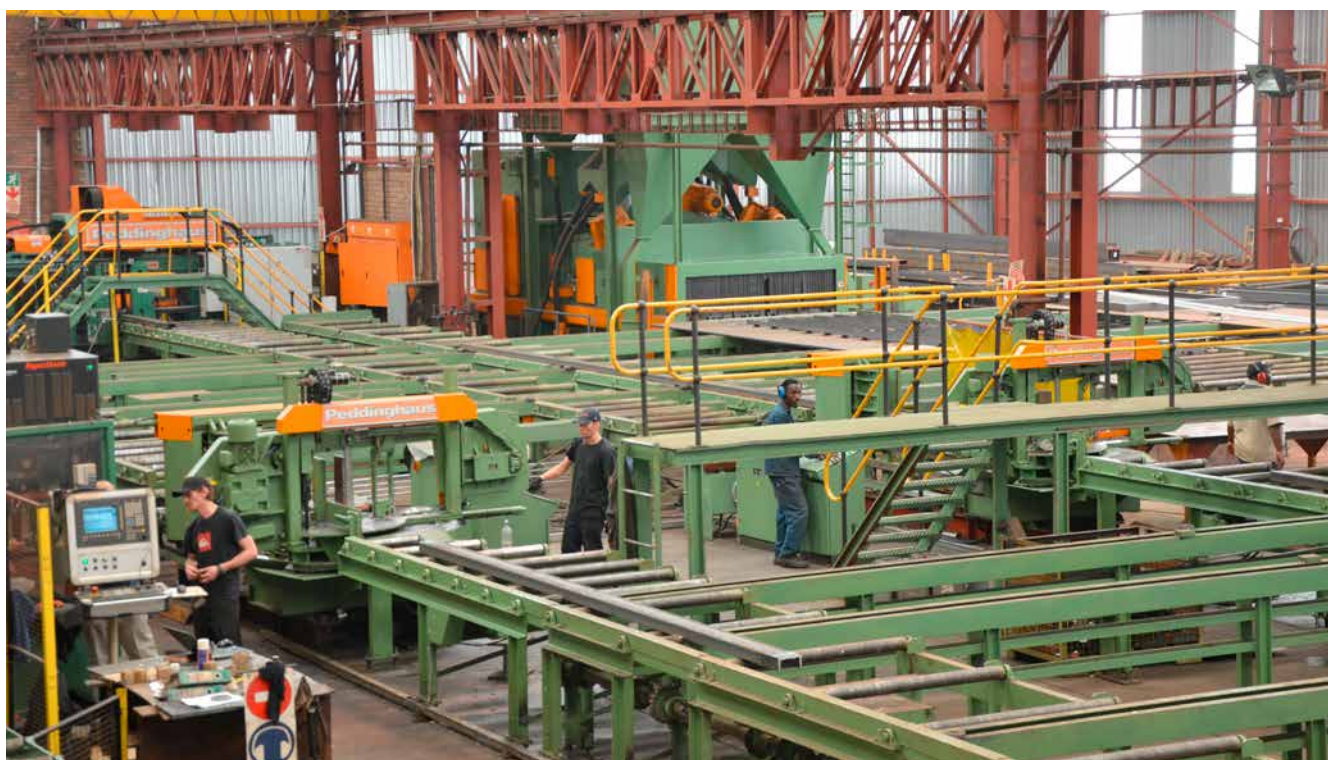
Strahlanlage mit Querförderer
