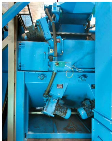
Strahlkammer mit den AGTOS Hochleistungsturbinen
