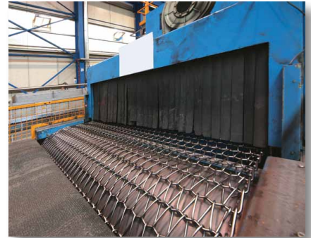
Werkstückauslaufseite mit Abblas-Ventilator
