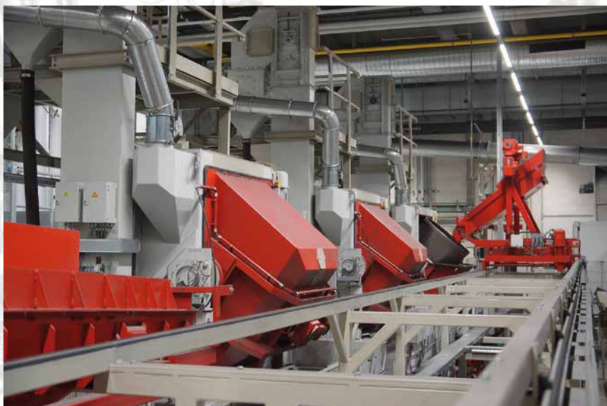
Un enchaînement permet de réaliser une production en continu avec les grenailleuses à tambour.
