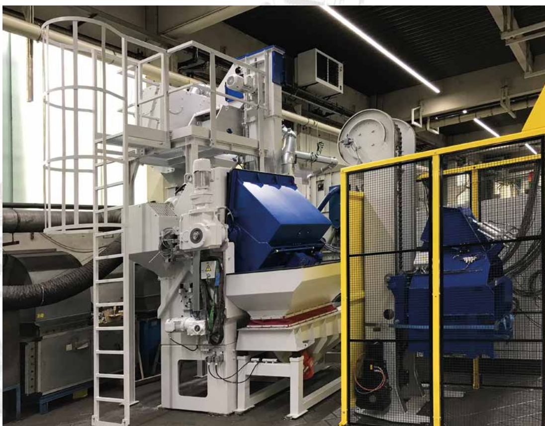
Grenailleuse à tambour AGTOS de type TS 150 pour nettoyer et solidifier de petits ressorts à lames.
