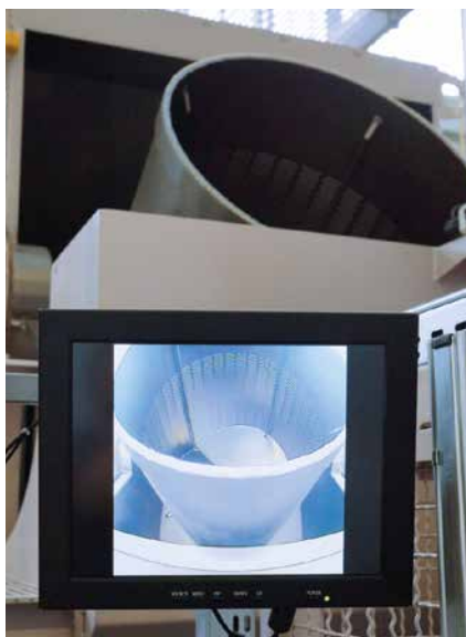
Un moniteur permet de surveiller l'opération de remplissage et de vidage
