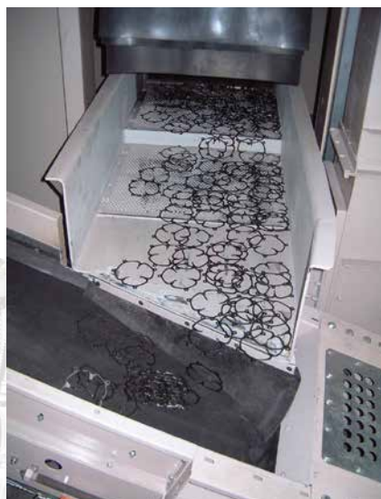
Ressorts sortant du couloir vibrant en aval
